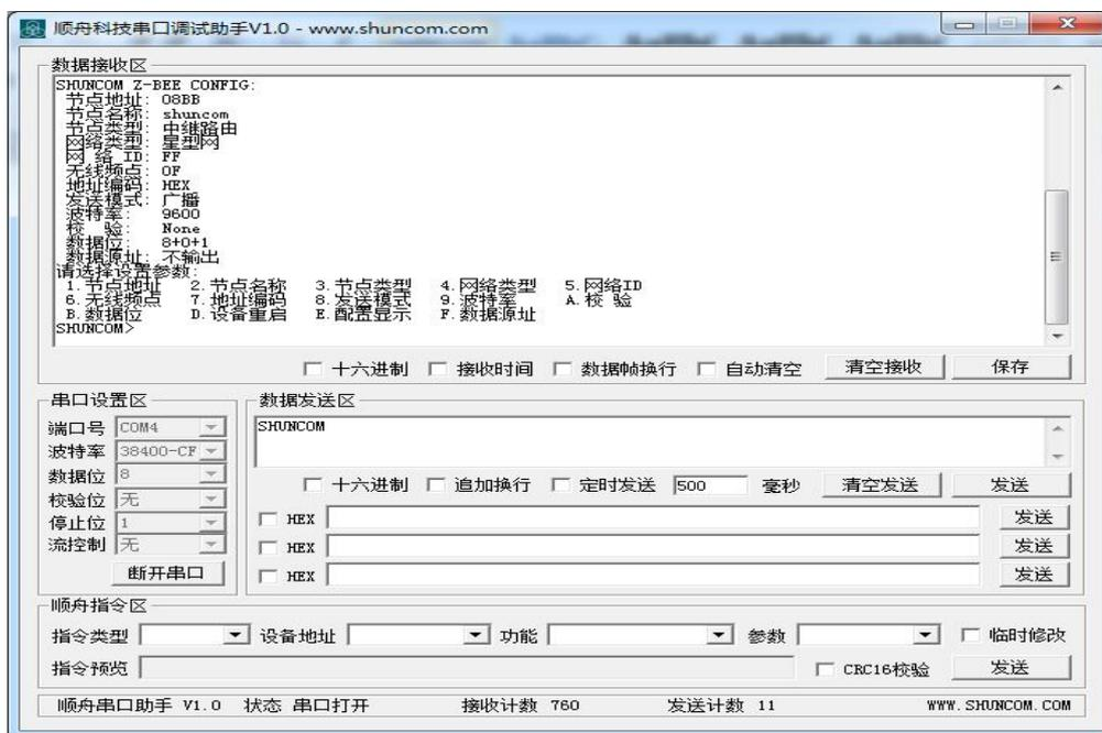
7、工具会自动显示出配置参数，如需修改参数设置，输入参数选项前的编号即可修改成功。
