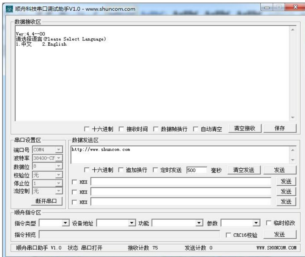
5、提示选择语言，输入 1 或直接敲击回车即可。工具会提示你输入安全码，直接输入“SHUNCOM”。
