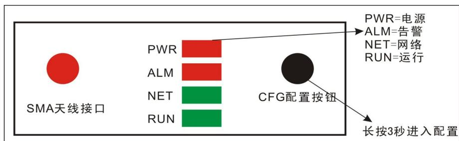
如果单独使用模块的话，把模块上面的 CFG 引脚拉低 3S 进入配置状态。
